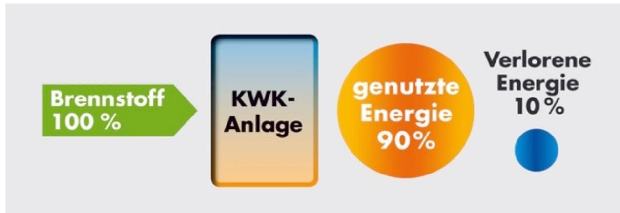
Wärme und Strom über eine Anlage!
